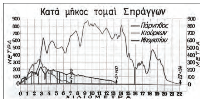
Εικ. 113 Κατά μήκος τομές των σηράγγων: Πάρνηθας, Κιούρκων και Μπογιατίου. Δείχνουν το υψόμετρο από το οποίο θα περνούσαν οι σήραγγες.
