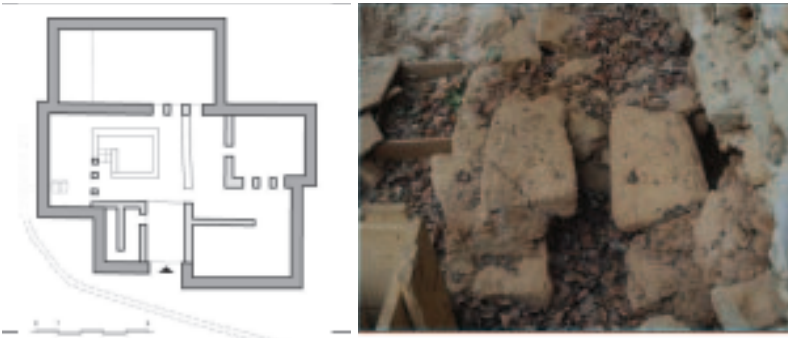
Εικόνα 6. Τουαλέτα στο κτίριο Da του ανακτόρου των Μαλίων. Κάτοψη του κτιρίου (αριστερά) και πρόσφατη φωτογραφία (δεξιά).
