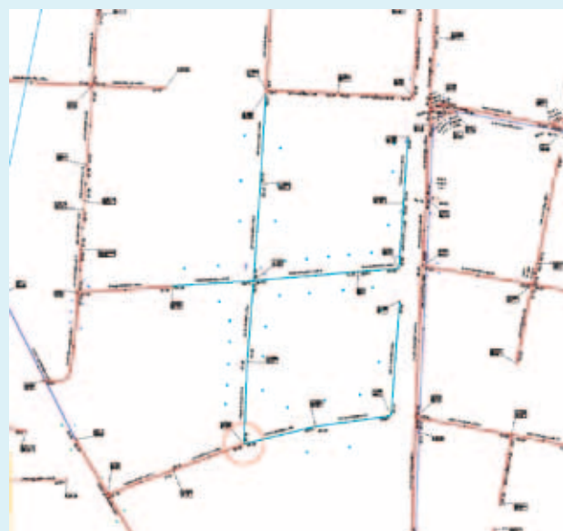
Εικόνα 3: Εφαρμογή Δένδρου Αποχέτευσης, Κτιρίων και Καταναλώσεων»
